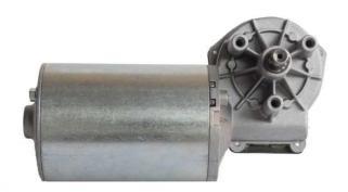
I motoriduttori a vite senza fine montano un motore a magneti permanenti bidirezionale. Il particolare profilo ad evolvente della vite senza fine, calettato sull'albero motore, si accoppia ad una corona dentata in materiale plastico con elevata resistenza all'usura. Il motoriduttore è particolarmente apprezzato per robustezza, silenziosità e la costanza di rendimento.
